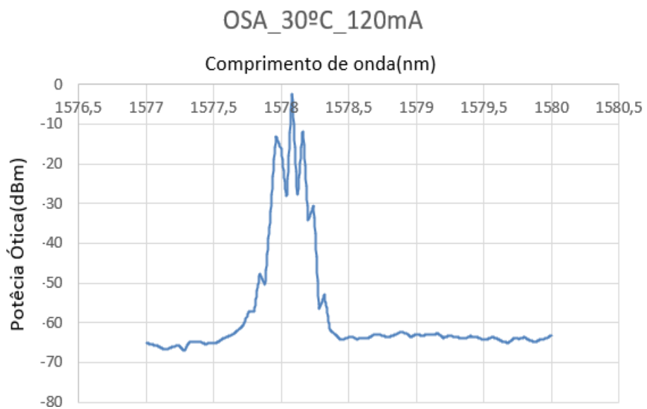
Figura 7.1.4 - Medição no Analisador de Espectro Ótico da Potência Ótica em relação ao comprimento de onda (30°C(120mA))
