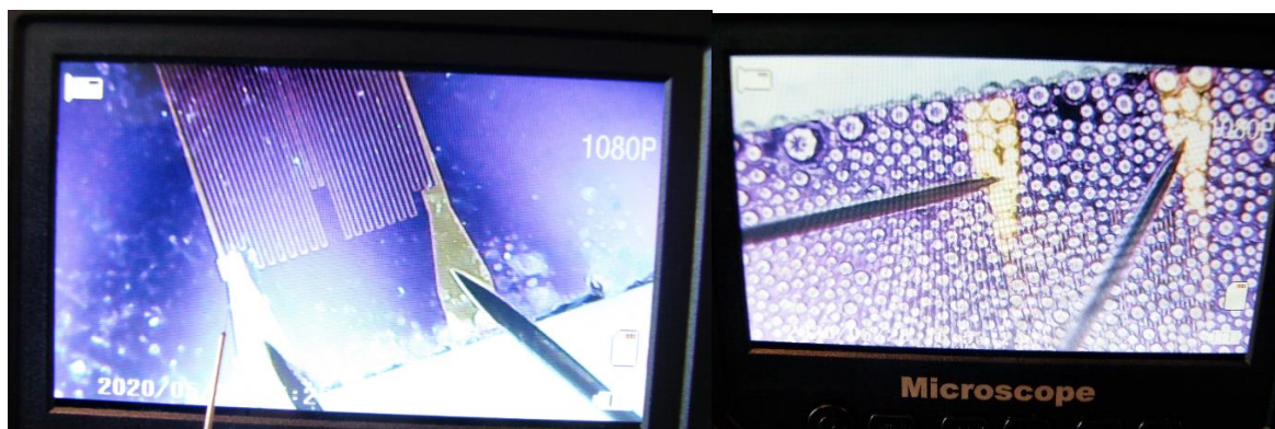
Figura 4.17 Sensor RTD sem condensação (à esquerda) e com condensação (à direita)
