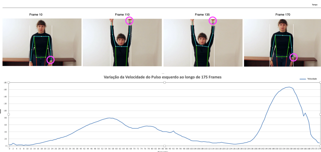
Figura 3.11: Ilustração da variação da velocidade de deslocamento para a mão esquerda. De realçar o movimento mais lento de elevação do braço do que o abaixamento.
