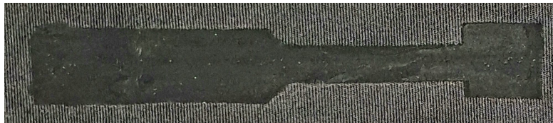
Figura 3.7: Elétrodo após ser retirado da prensa.
