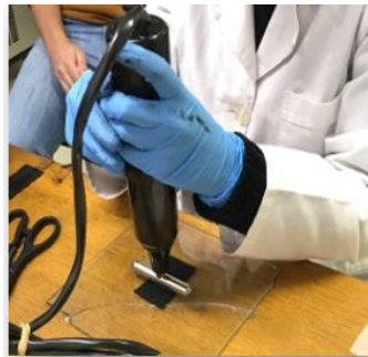
Figura 3.2: Aplicação da Técnica de Corona nos tecidos.
