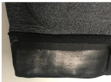
Figura 3.8: Elétrodo após passagem pela calandra.
