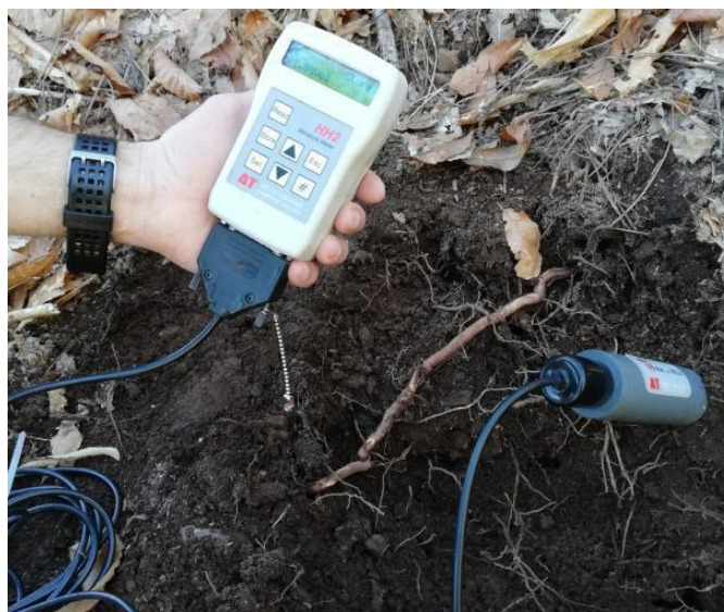
Figura 2.2 – Medidor de teor de humidade da marca Delta-T Devices HH 2.
