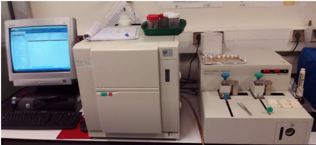
Figura 2.19 - Equipamento da marca TOC-VCPH SHIMADZU com o módulo Solid Sample Module SSM-5000ª acoplado utilizado na determinação do COT.
