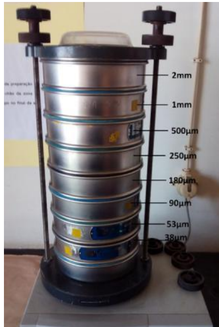
Figura 2.6- Sequência de peneiros (2 mm; 1 mm; 500 µm; 250 µm; 180 µm; 90 µm; 53 µm; 38 µm) utilizada para a peneiração das amostras colhidas na Serra da Estrela.
