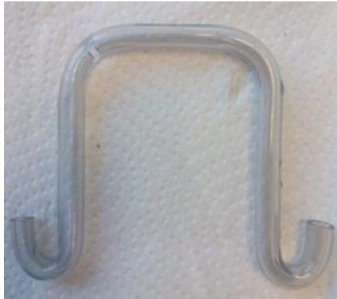
Figura 2.11 - Sifão utilizado para permitir a passagem da água da amostra até a buretas de medição.
