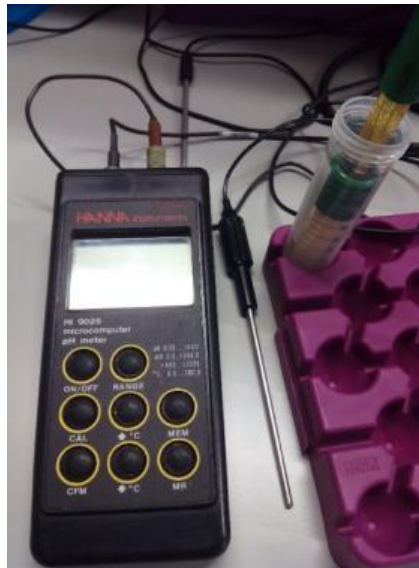
Figura 2.14 - Amostra (As3) pesada para o ensaio de medição do pH em solução de \text{CaCl}_2 e \text{H}_2\text{O} ; (direita) Solução de \text{H}_2\text{O} e \text{CaCl}_2 utilizadas nos ensaios de determinação do pH.
