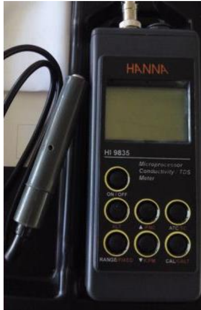
Figura 2.13 – Medidor de condutividade elétrica de marca HANNA modelo HI 9835 utilizado nas medições.
