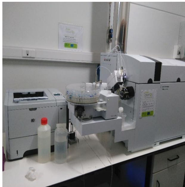
Figura 2.21- ICP-MS Agilent modelo 7700, utilizado na análise química dos elementos maiores e vestigiais das amostras.
