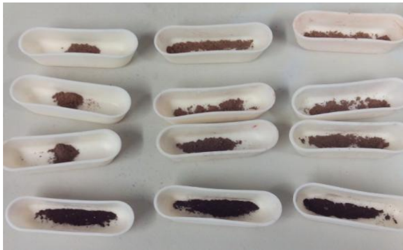
Figura 2.18 – Cadinhos de cerâmica utilizados nas determinações de COT nas amostras de solo.
