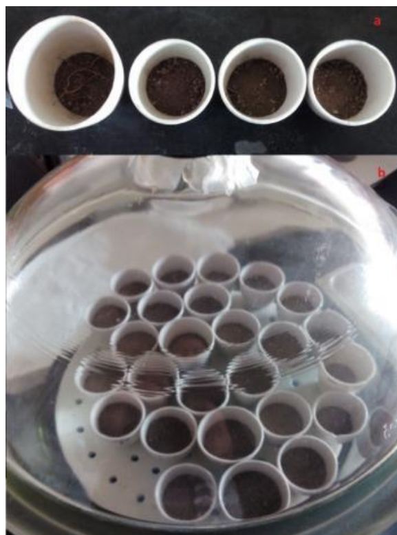
Figura 2.16 - (a) Cadinhos previamente pesados e amostras preparadas para a determinação da matéria orgânica; (b) Amostras dentro do exsiccador apos terem sido colocadas na estufa durante 24 horas.
