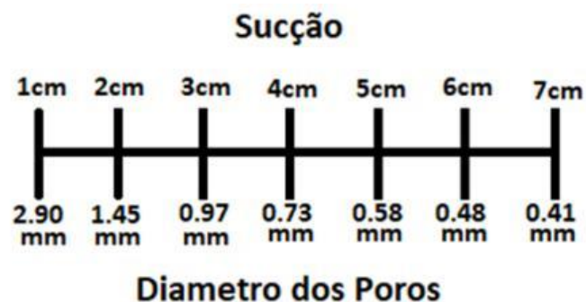
Figura 2.5 - Tabela que mostra a relação entre a sucção selecionada no infiltrómetro e a dimensão dos poros. (Adaptado de http://www.decagon.com.br/hidrologia/conductividade/mini-disk/ )
