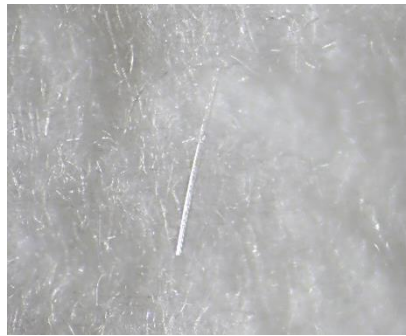
Figura 16- Fotografia obtida por microscopia ótica, com uma lente de ampliação 10x a uma fibra sintética.
