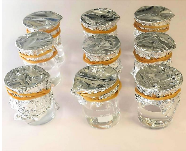
Figura 6- Conteúdo resultante das amostras em análise, imerso numa solução de H_2O_2 a 15%.
