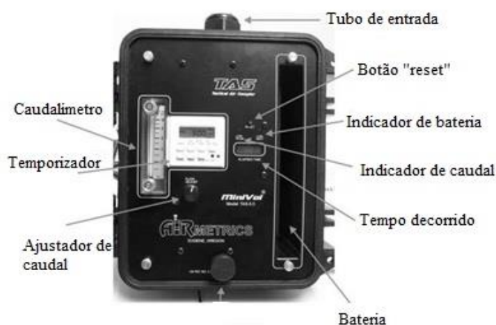
Figura 2- Visão externa do amostrador MiniVol™ TAS .
