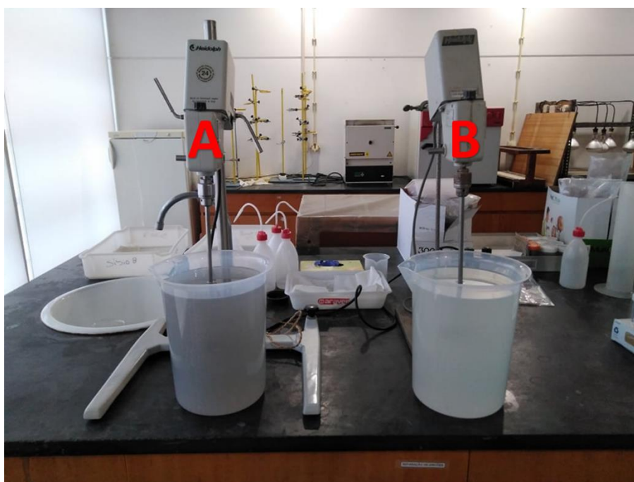
Figura 4.22: Amostra do tanque de aeração (A) e da Linha 2 (B) sob agitação mecânica.
