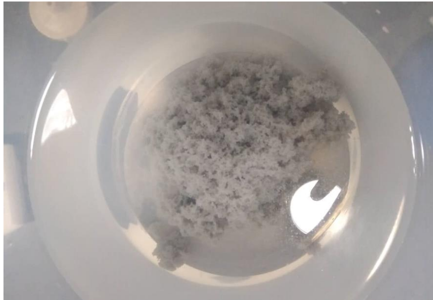
Figura 4.23: Exemplo do aspeto dos flóculos formados na amostra da Linha 2.
