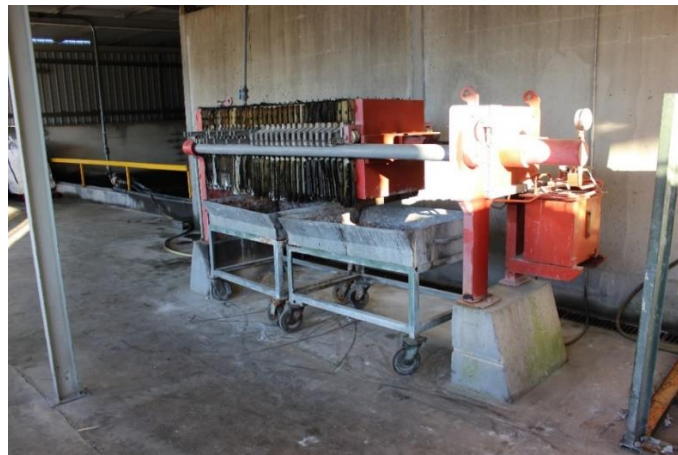
Figura 4.8: Filtro-prensa usado para secagem das lamas.
