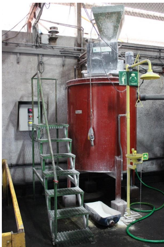
Figura 4.4: Primeiro reator onde se faz a adição de \text{Ca(OH)}_2 .
