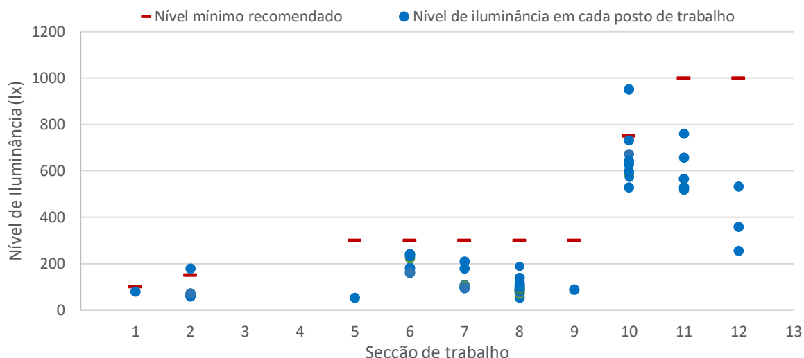
Figura 21 - Níveis de iluminância em cada posto de trabalho da unidade 3 no período noturno.
