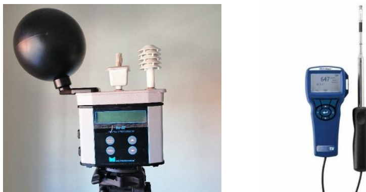
Figura 7 – Instrumentos de medição utilizados para a avaliação do conforto térmico, marca “METROSONICS” e “TSI”.
