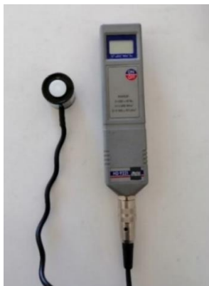
Figura 14 - Equipamento de medição de iluminância, luxímetro "Delta Ohm".
