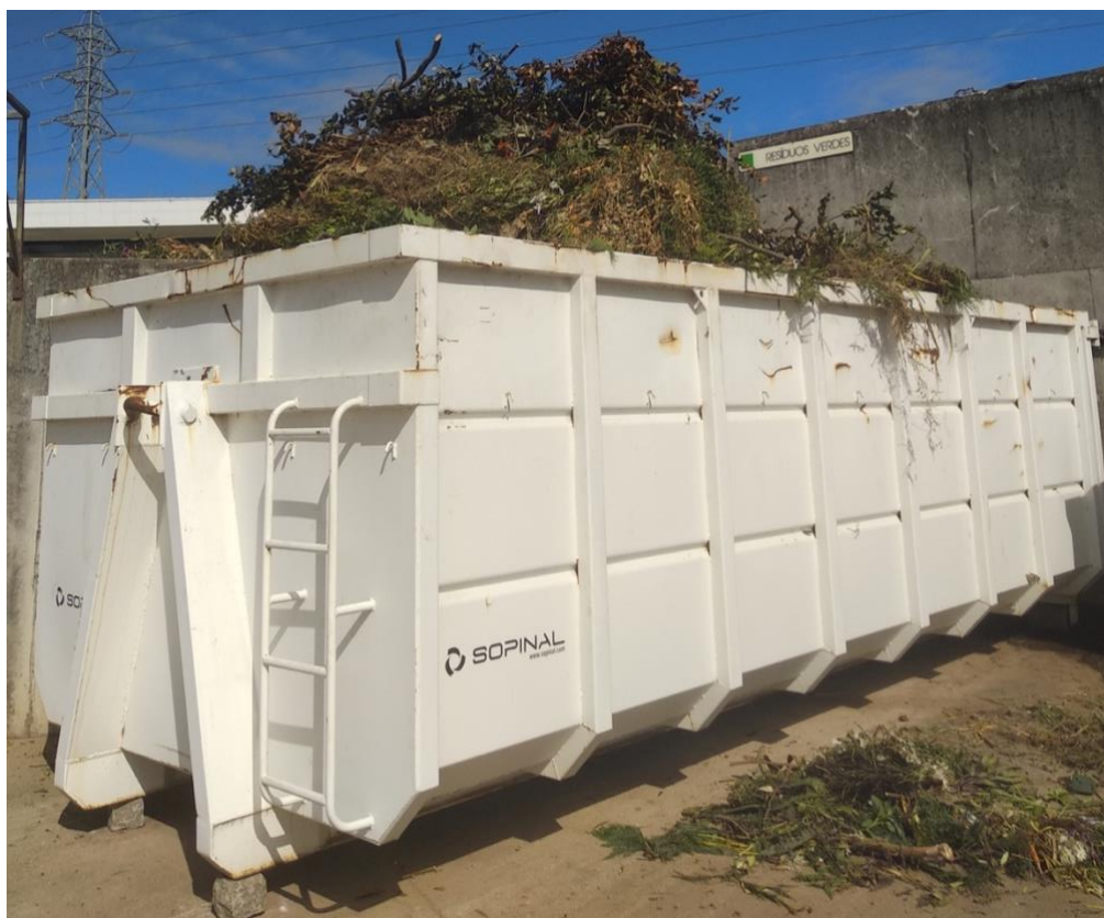
Figura 4.12 - Caixa de 20 m 3 para deposição de resíduos verdes provenientes do PaP.
