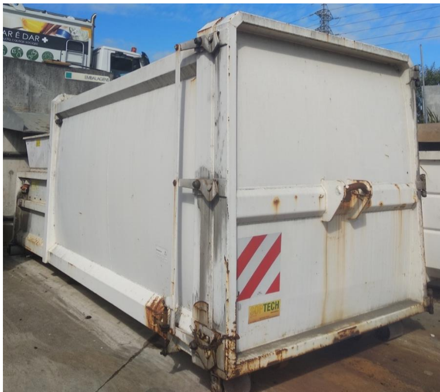
Figura 4.10 - Compactador de 20 m 3 para deposição de resíduos de papel/cartão ou embalagens provenientes do PaP.
