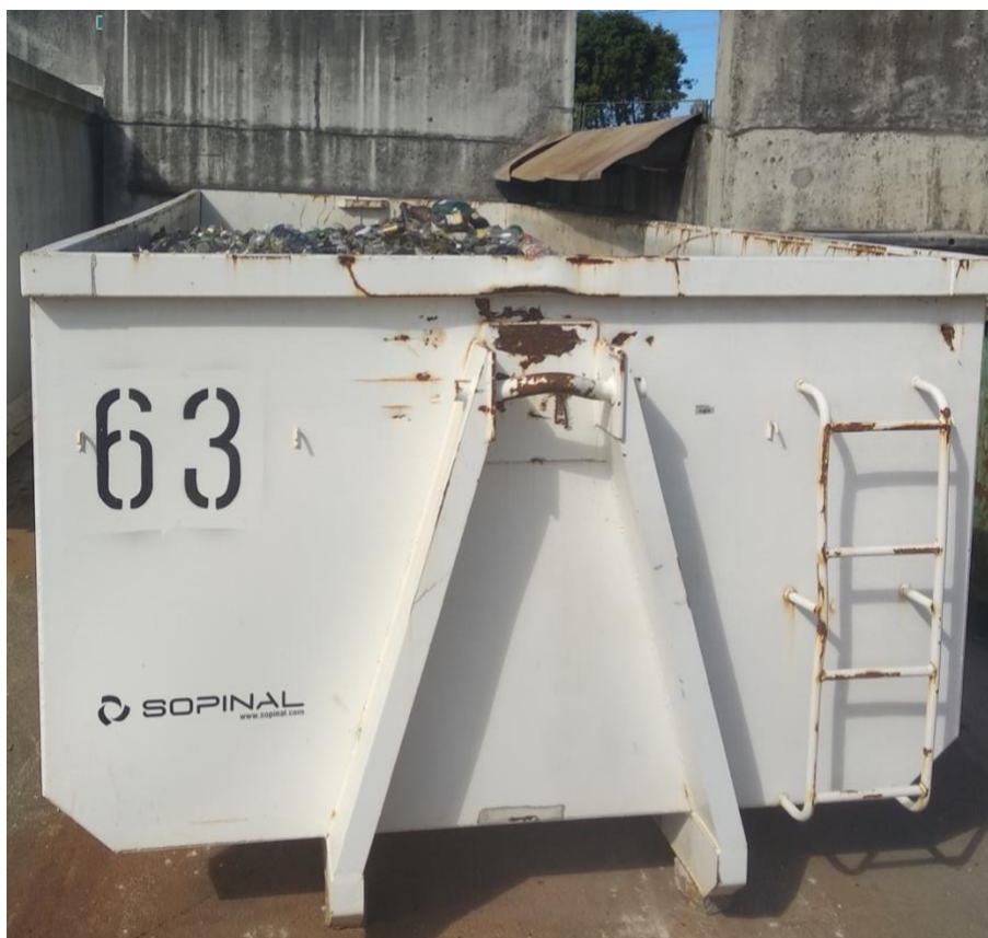
Figura 4.11 – Contentor de 20 m 3 para deposição de resíduos de vidro provenientes do PaP.
