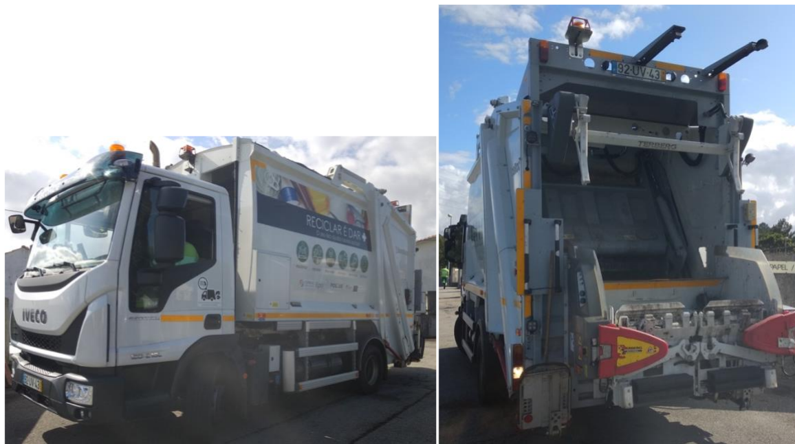
Figura 4.7 - Viatura movida a gás natural utilizada para a recolha de indiferenciados e multimaterial trifluxo.
