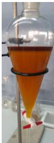
Figura 4.2 Exemplo de uma mistura reacional na etapa de decantação, durante a qual não ocorreu a decantação da glicerina.
