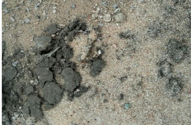
Figura 5.31-Fenômeno de aglomeração do leito após experiência de gasificação e co-gasificação, com incorporação até 100% m/m de CDR em pellets.
