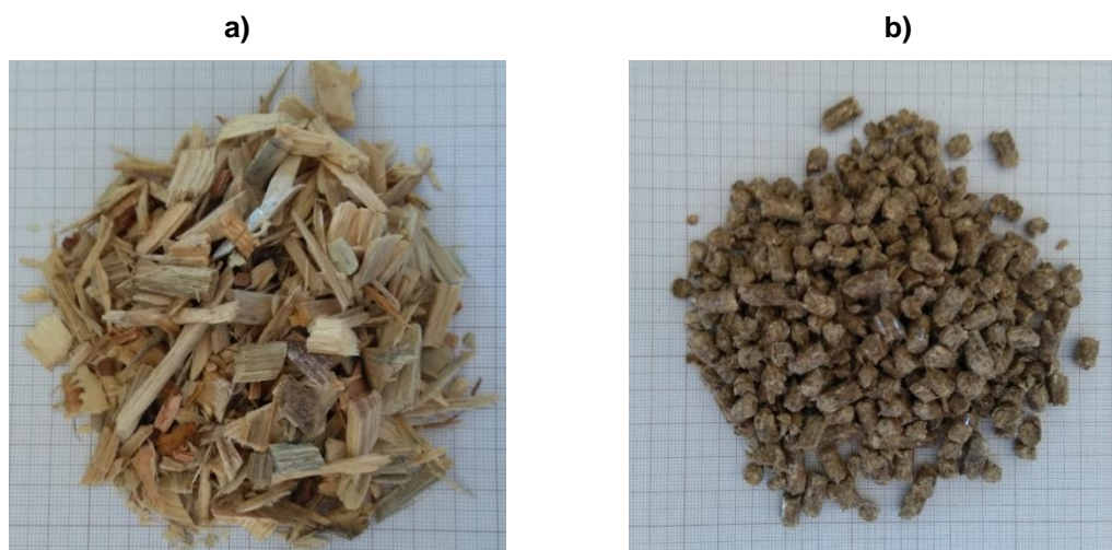
Figura 4.15- Aspeto macroscópico de a) estilha de pinheiro e b) pellets de madeira, sobre papel milimétrico.
