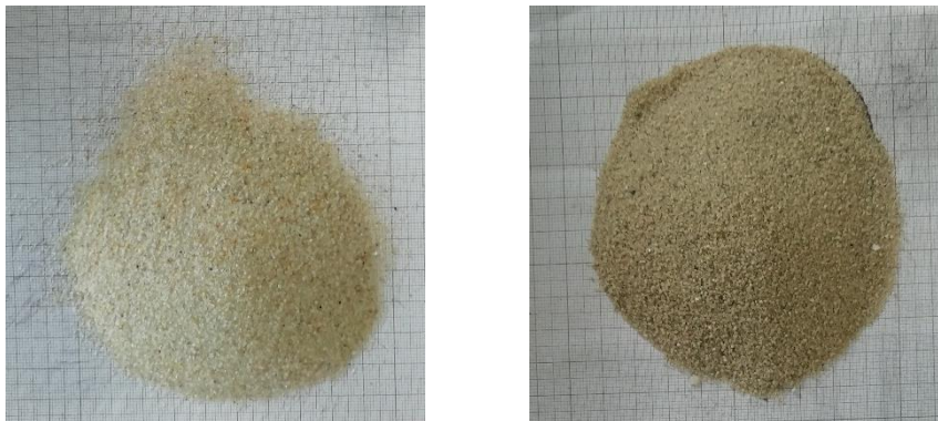
Figura 5.30- Aspeto macroscópico do leito: a) antes e b) após experiência de gasificação, sobre papel milimétrico.
