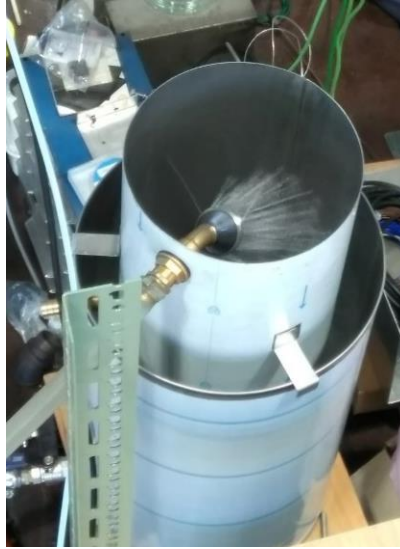
Figura 4.6- Torre de arrefecimento do sistema de arrefecimento primário.
