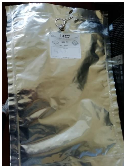
Figura 4.28- Saco vazio, para amostragem de gás, de 10 L.
