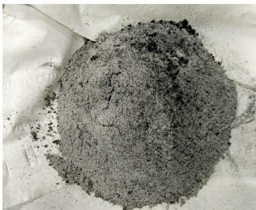
Figura 5.28- Aspeto macroscópico de cinzas volantes, recolhidas após experiências de co-gasificação e gasificação.
