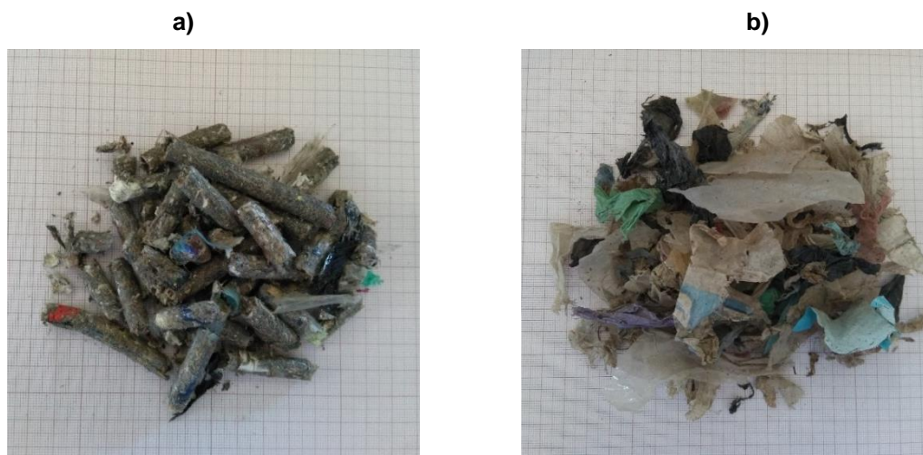
Figura 4.16- Aspeto macroscópico de a) CDR em pellets e b) CDR em fluff, sobre papel milimétrico.
