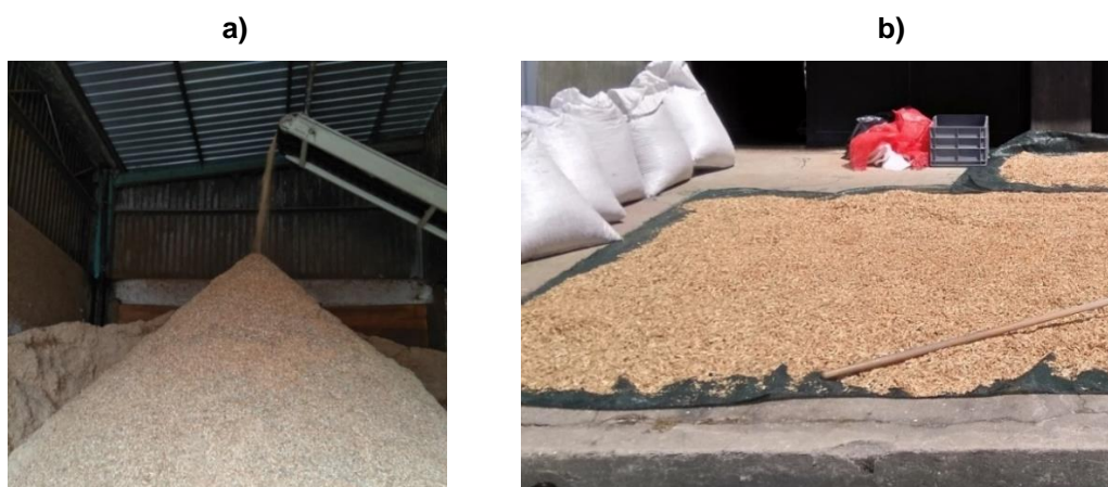
Figura 4.13- a) Recolha e b) secagem da estilha de pinheiro, fornecida pela empresa Madeca-madeiras de Caxarias Lda..
