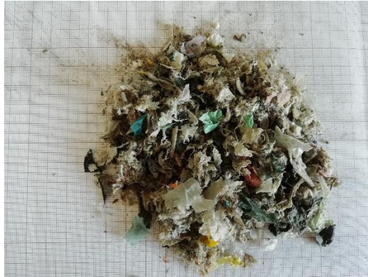
Figura 4.20- CDR em fluff triturado, sobre papel milimétrico.
