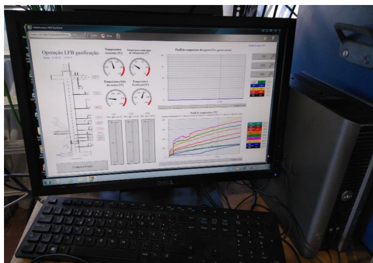
Figura 4.29- Controlo dos dados operatórios durante uma experiência de gasificação no software HMI.
