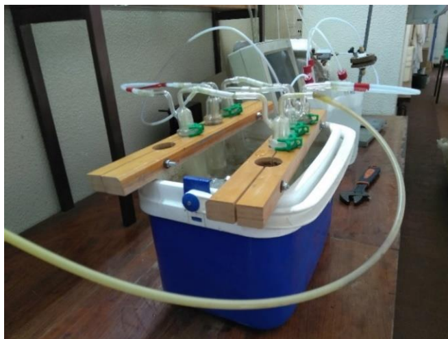
Figura 4.9- Conjunto de borbulhadores para limpeza do gás amostrado.
