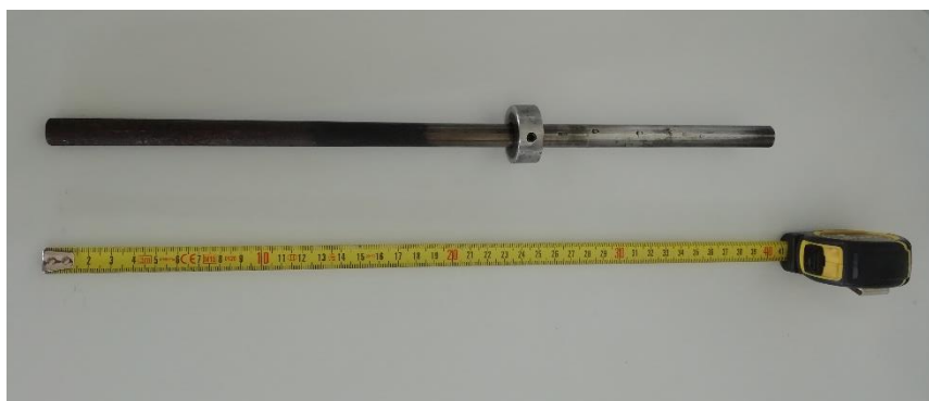
Figura 4.27- Sonda de amostragem de gás utilizada nas experiências de gasificação.
