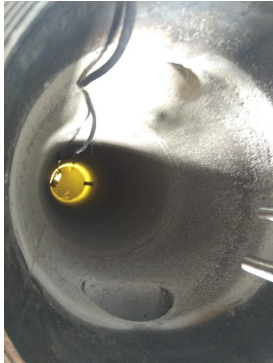
Figura 5.29- Interior do reator após experiência de gasificação.
