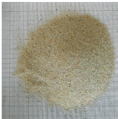
Figura 4.3- Areia siliciosa fornecida pela empresa IMOSA-Indústrias Mineiras do Mondego, S. A. peneirada.
