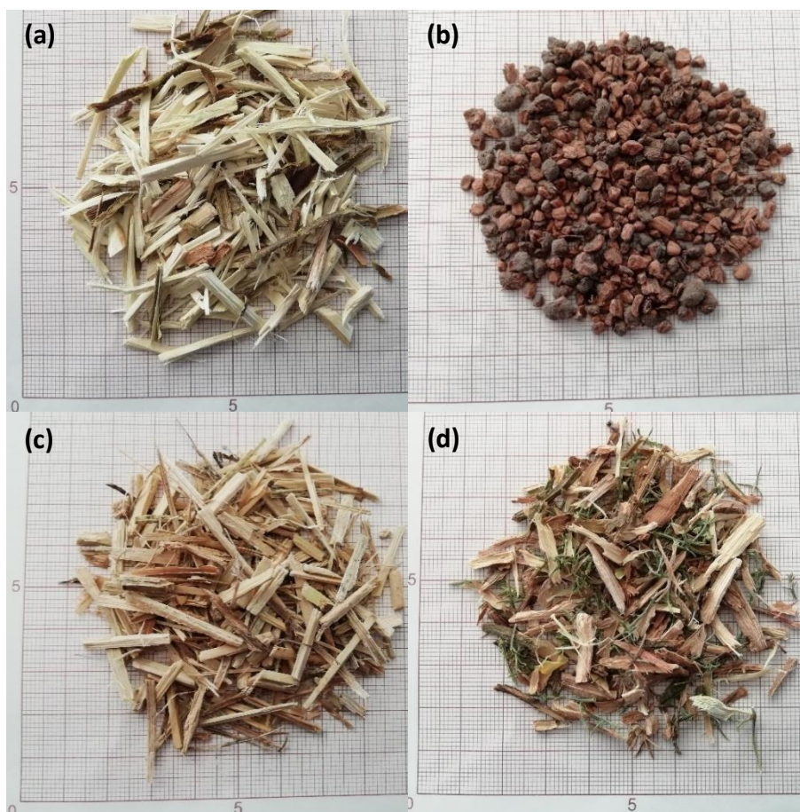
Figura 4.4 – Amostras com dimensões entre 2 e 4 mm utilizadas para o processo de pirólise: Troncos de acácia com casca (a), Bagaço de azeitona (b), Troncos de canas (c), Tojos (d).
