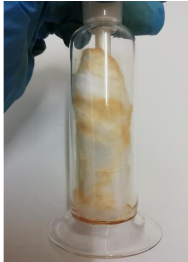
Figura 4.12 – Bio-óleo retido no algodão colocado nos condensadores.
