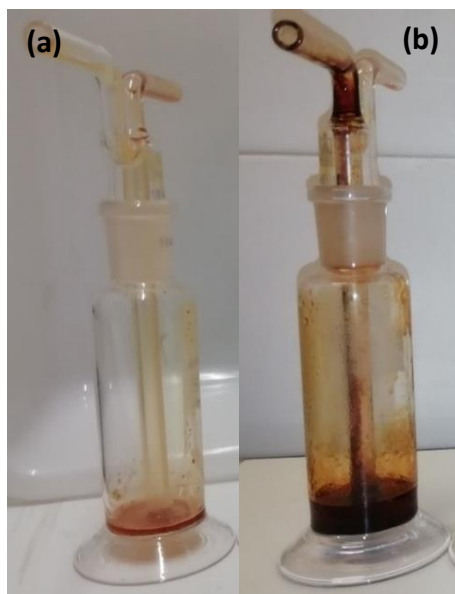
Figura 5.21 – Primeiro condensador da montagem experimental para um ensaio com acácia (a) e um ensaio com bagaço de azeitona (b).
