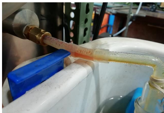
Figura 4.11 – Saída de gases e bio-óleo do reator.
