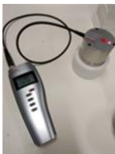
Figura 16 – Medição da amostra no aparelho HygroPalm HP23-AW-A.
