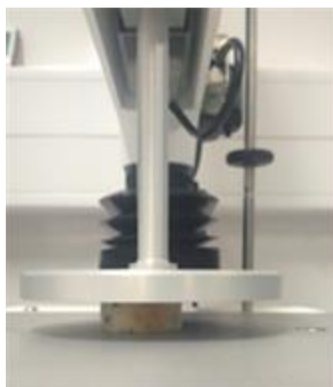
Figura 17 – Compressão da amostra da experiência 3 no Texturómetro TA.XTPlus Connect Stable Micro Systems, acoplado com uma sonda cilíndrica de 100 mm e uma célula de carga de 30 kg.
