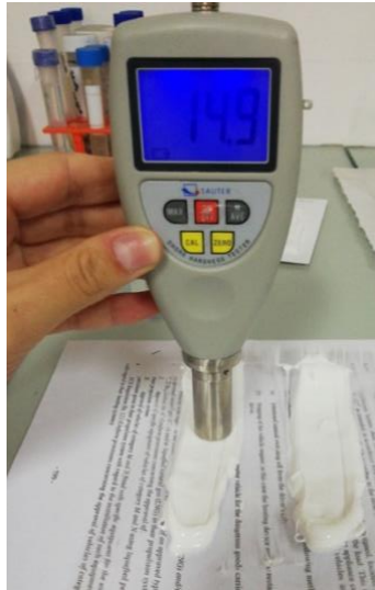
Figura 10-Utilização do durómetro na medição da rigidez
