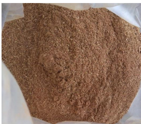
Figura 13 – Granulometria obtida com crivo de 2 mm.
