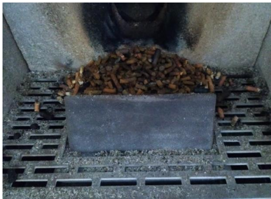
Figura 27 – Grelha da câmara de combustão no fim do ensaio de combustão.
