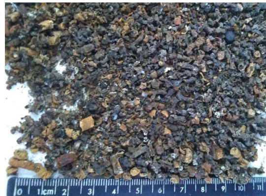
Figura 28 – Cinzas e inqueimados resultantes do ensaio de combustão.
