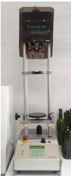
Figura 26 – Sistema de medição de forças de extração *ExtraLab*.
