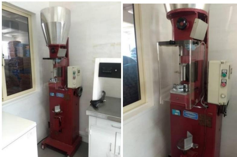
Figura 23 – Engarrafadora automática da marca *Bertoloso*, modelo *Epsilon R/S*.
