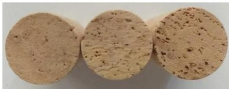
Figura 20 – Classificação das rolhas técnicas. Da esquerda para a direita as classes são: A, B e C.
