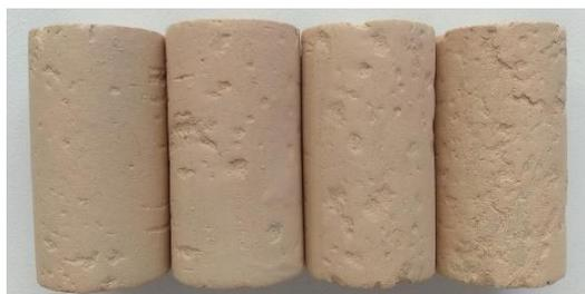
Figura 19 – Classificação das rolhas colmatadas. Da esquerda para a direita as classes são: superior, A, B e C.
