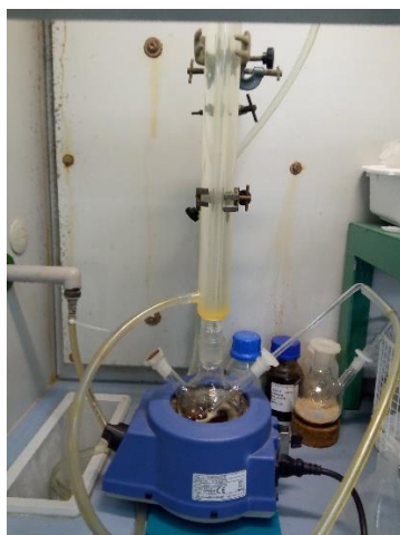
Figura 14: Esquema de montagem da extração alcalina com NaOH 0,3% (m/V).
