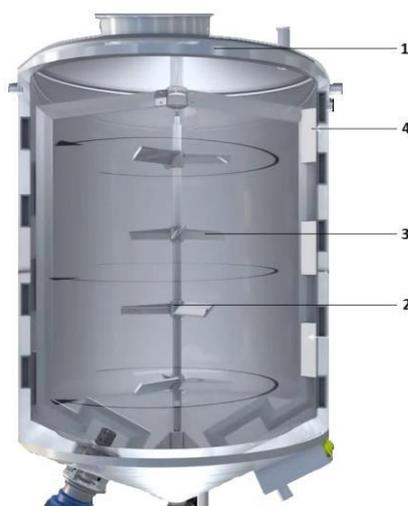
Figura 2.2.1 – Esquema de um CSTR. Adaptado de [17].
