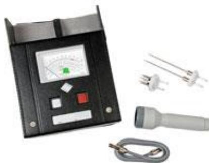
*Figura 14-Aquaboy utilizado na medição da humidade das rolhas [50].*
