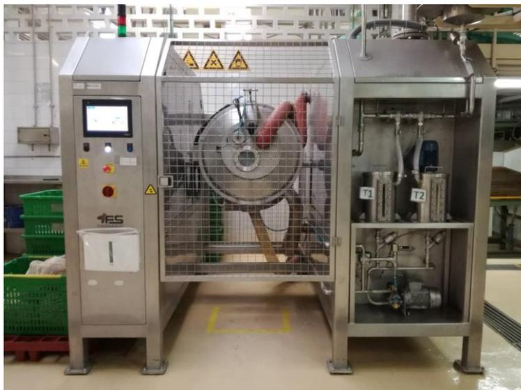
*Figura 20-Máquina de lavação utilizada nos ensaios à escala piloto.*
