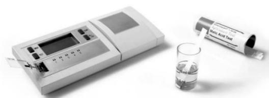
*Figura 15-Equipamento utilizado para medir o teor de peróxido residual.*
