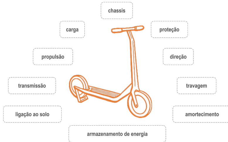
Figura 3.6: Arquitetura de produto - Diagrama de sistemas (trotineta)
