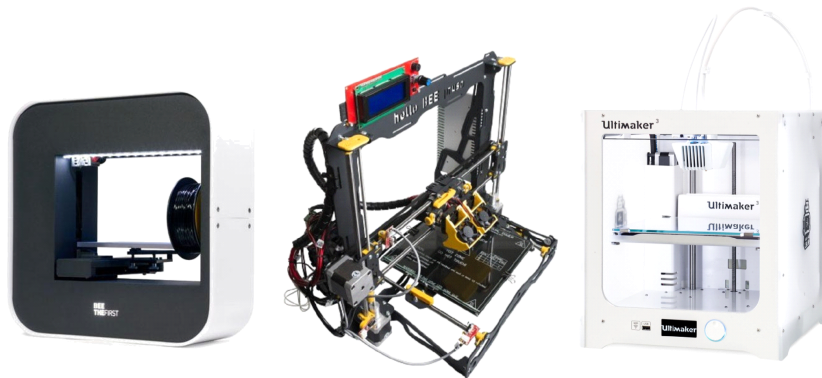
Figura 6.7: Equipamentos utilizados na execução do protótipo: BEETHEFIRST à esquerda, HELLOBEEPRUSA ao centro e Ultimaker 3 à direita
