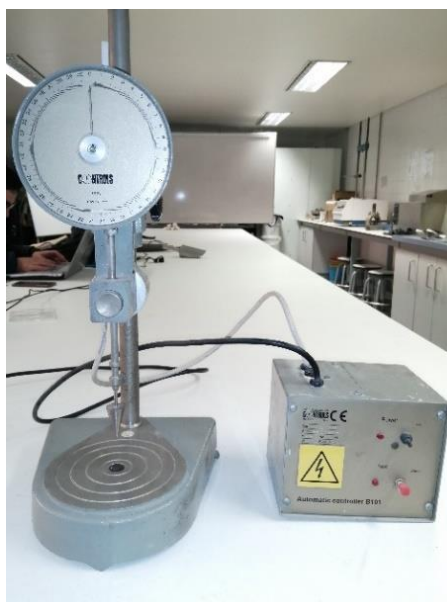
Figura 3.5- Instrumento para determinar o limite de liquidez pelo fall-cone test .
