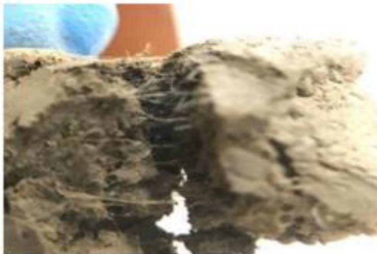
Figura 2.26- Mistura do solo, fibra e água [Wang et al. (2019)].
