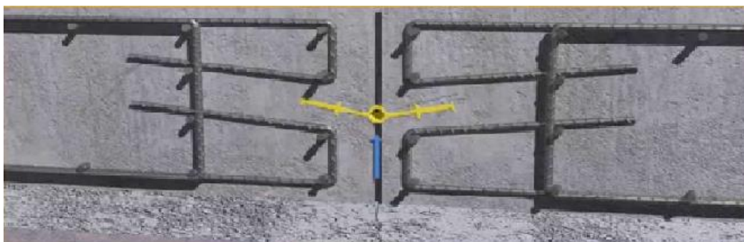
Figura 17 - Selagem ativa das juntas com o produto Sika Water Bar (Sika)
