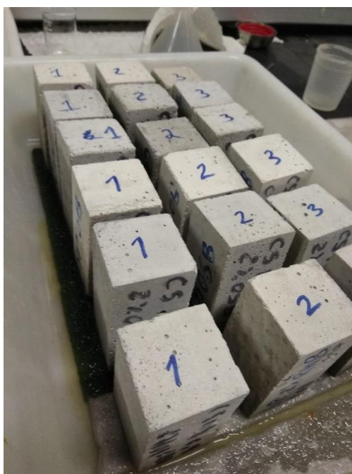
Figura 64 – Provetes no tabuleiro com água e pesagem
