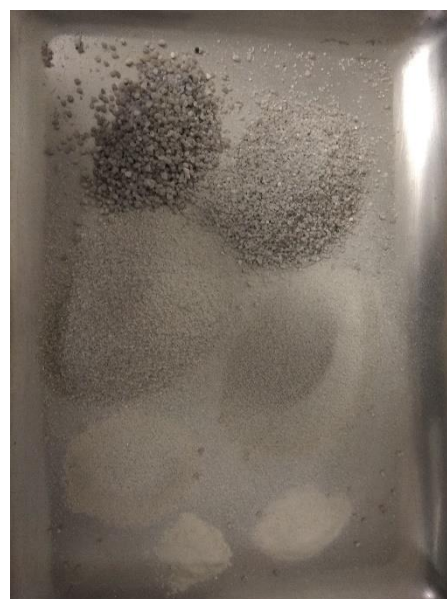
Figura 48 - Areia peneirada e separada após a pesagem
