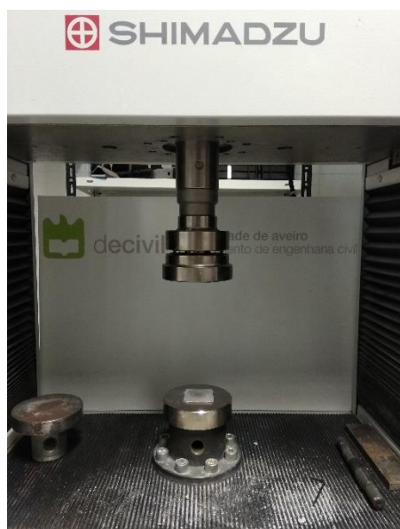
Figura 67 - Acessórios usados para o teste de compressão
