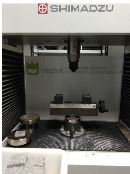
Figura 65 - Acessórios usados para o teste de flexão
