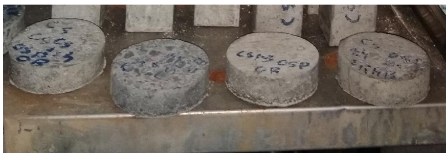
Figura 70 - Provetes para realização do teste de condutividade térmica
