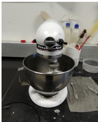
Figura 59 – Misturadora usada na preparação da argamassa
