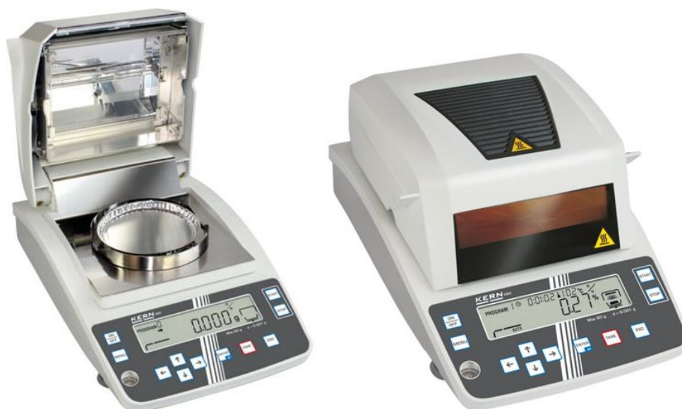
Figura 24. Balança da marca KERN com o prato da amostra e o vidro com a lâmpada de halogénio que mede o teor de humidade, aberta e em funcionamento. 72
