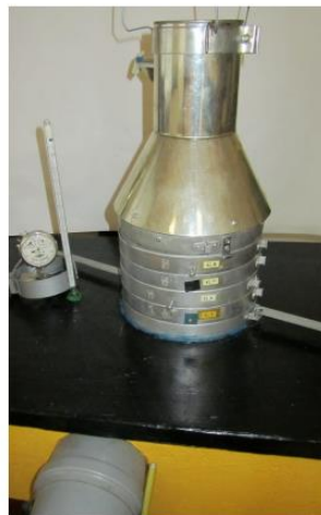
Figura 18. Dreche seca por ventilação. 57
