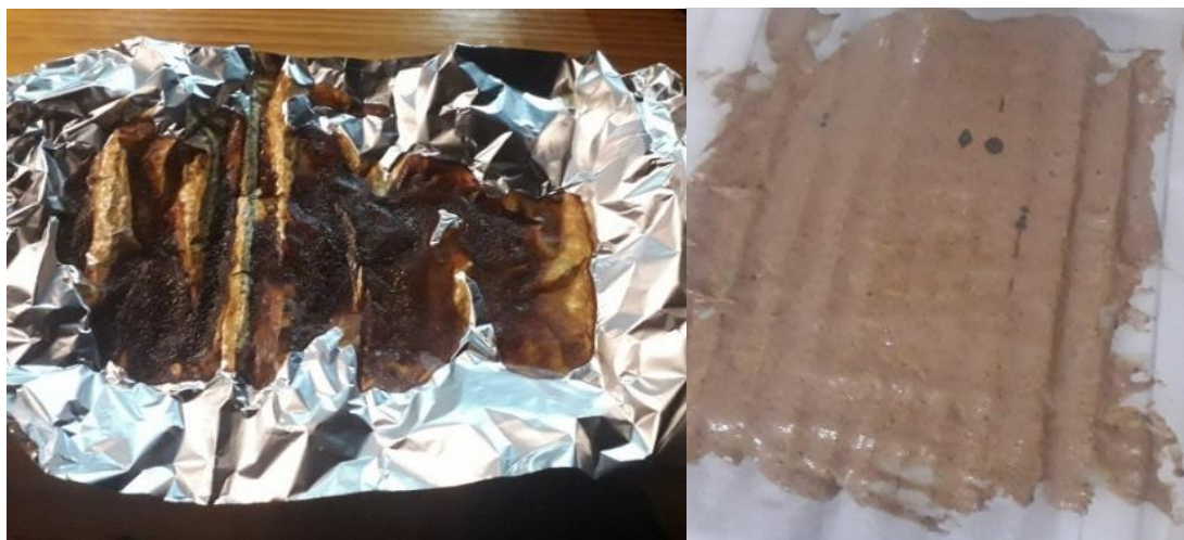
Figura 31. Levedura seca após a secagem no forno à esquerda e após a secagem com secador à direita.
