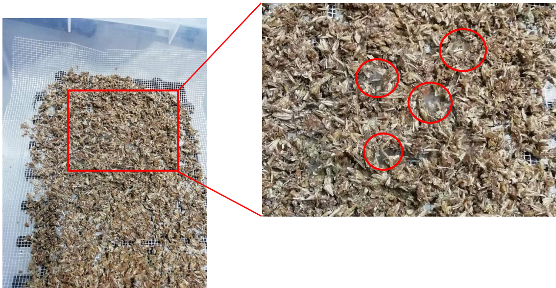
Figura 28. Mistura de dreche com lúpulo gasto com formação de bolores ao final de 6 dias de secagem.
