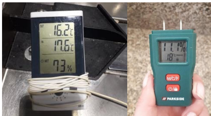
Figura 26. Aparelho de medição de temperatura e humidade do ar nas instalações fabris à esquerda e aparelho de medição do teor de humidade adaptado para a dreche.
