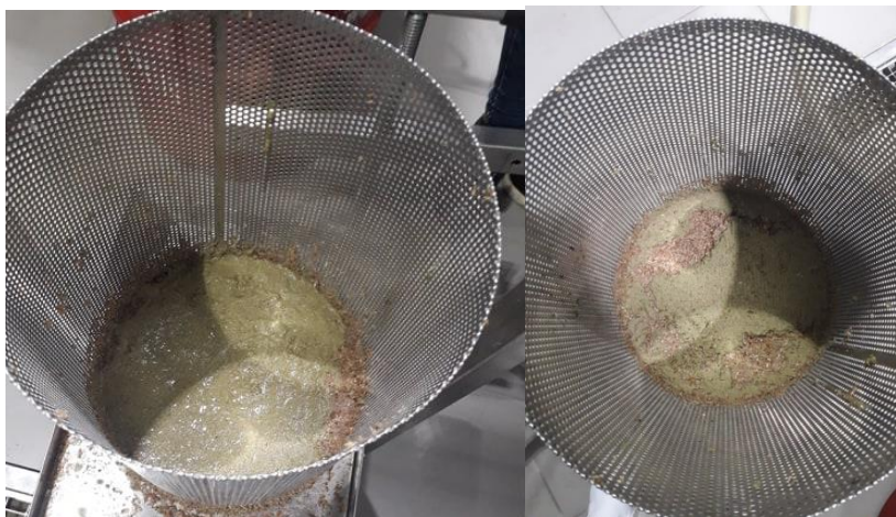
Figura 20. Vista de cima do equipamento antes (à esquerda) e após (à direita) a remoção de água com a prensa da mistura de dreche e hot trub.
