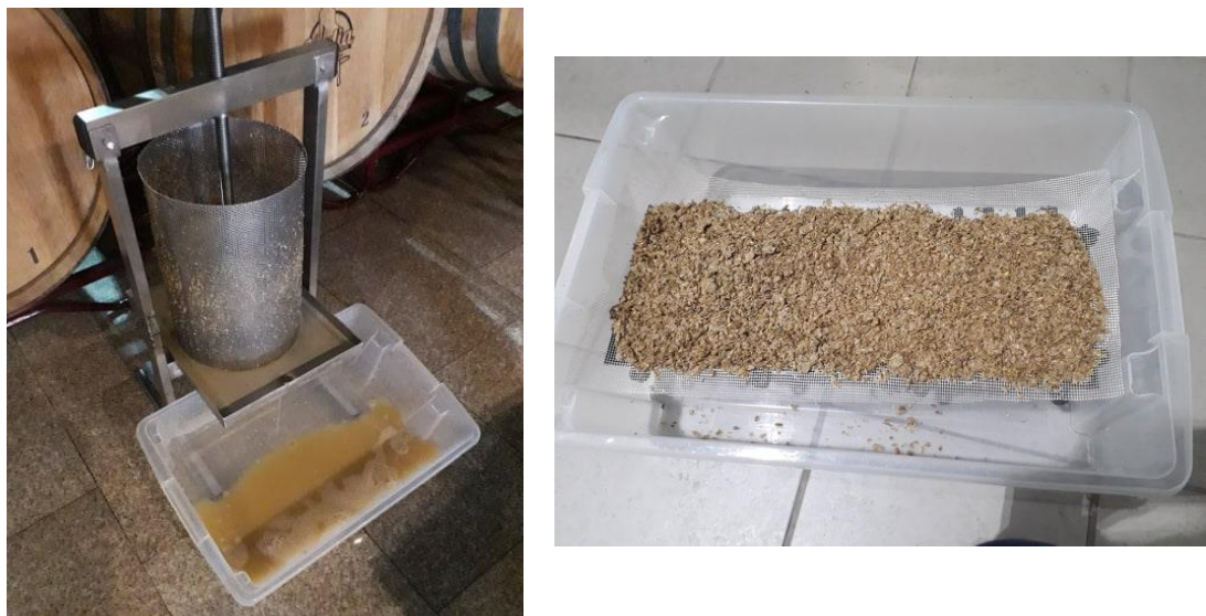
Figura 19. Disposição da dreche nos dois processos de secagem. À esquerda a dreche numa prensa e à direita a dreche colocada sobre uma rede e grade.
