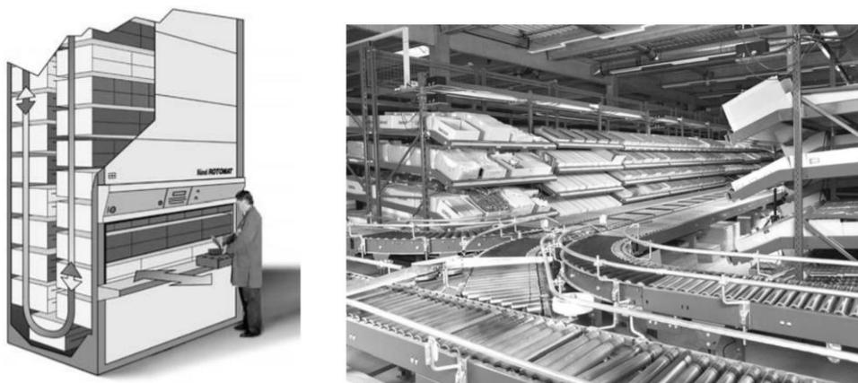
**Figura 10** - *Rack* rotativo vertical (esquerda) e *flow rack* com *conveyor* (direita) (fonte Hompel & Schmidt, 2007, p.104-106)
