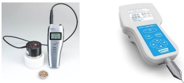
**Figura 7** – Equipamentos utilizados na medição da atividade de água (HygroPalm HP23-AW-A), à esquerda, e do nível de oxigénio (Oxybaby®), à direita, nas amostras.
