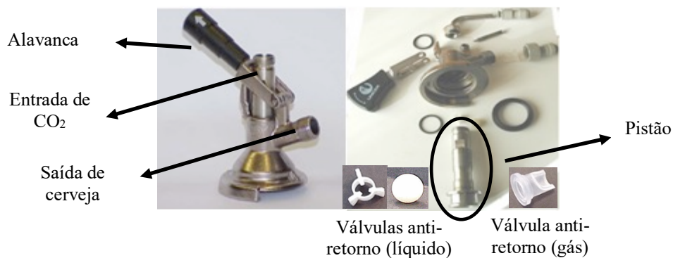
Figura 2.6 Esquema do click montado (à esquerda) e desmontado (à direita) 18
