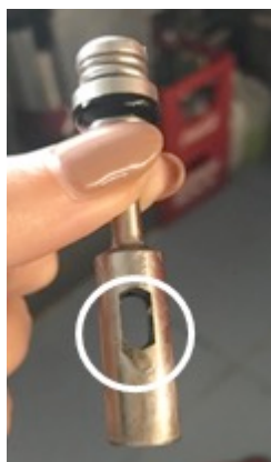
Figura 4.1 Pistão de uma torneira Mafridis com contaminação.
