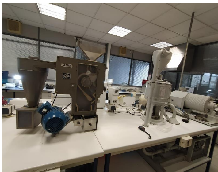
Figura 2 - Processo de tratamento do arroz em escala laboratorial; à esquerda encontra-se o descascador, seguidamente o branqueador
