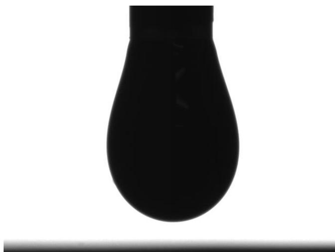
Figura 10 – Exemplo de imagem da gota utilizada nas medidas de tensão superficial.
