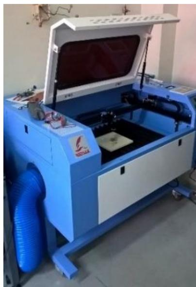
Figura 12 – Sistema laser Redsail utilizado no trabalho.
