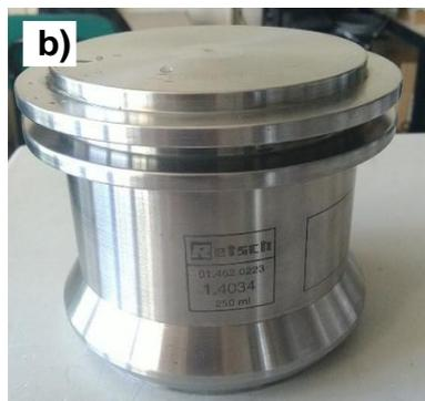
Figura 7 – a) Moinho de bolas planetário Retsch PM 400 e b) cuba utilizada na moagem.
