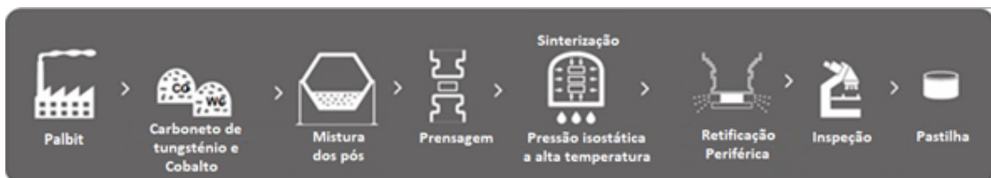
Figura 6.1: Processo de produção das pastilhas de metal duro adaptado de [8].
