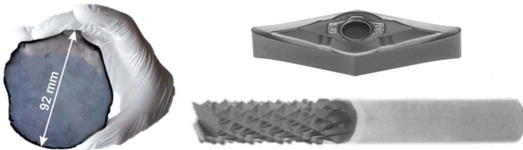
Figura 3.1: Diamante CVD em placas à esquerda [12] e como revestimento de ferramentas de metal duro à direita [18].
