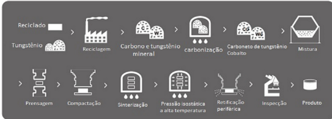
Figura 2.1: Representação do processo de obtenção do metal duro [8].
