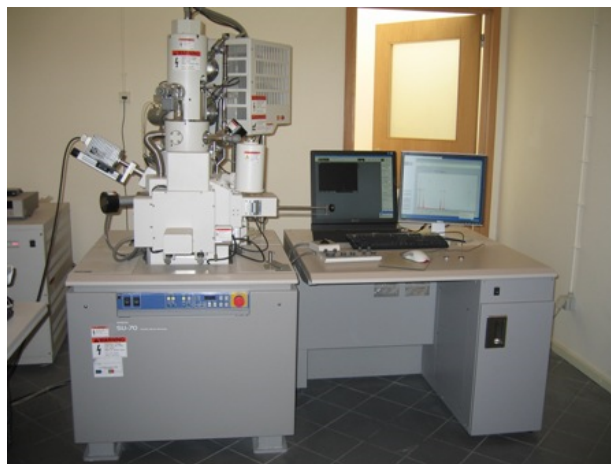
Figura 6.13: Microscópio Electrónico de Varrimento, equipamento pertencente ao Departamento de Engenharia de Materiais e Cerâmica da Universidade de Aveiro [52].
