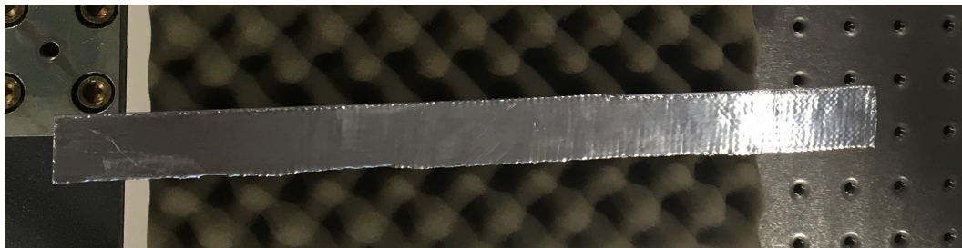
Figura 4.9: Viga com tratamento da 3M espesso
