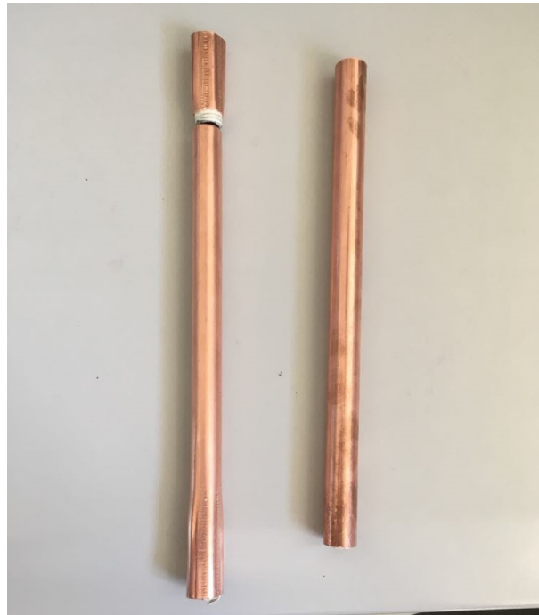
Figura 3.14: Provete partido na zona da agarra
