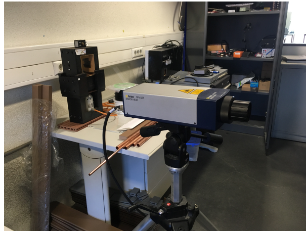
Figura 3.6: Suporte do Vibrômetro Laser
