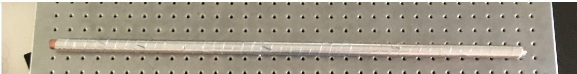
Figura 4.29: Tubo com tratamento da 3M espesso em Espiral
