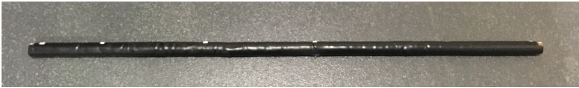
Figura 4.33: Tubo com manga termorretrátil HellermanTyton HA67
