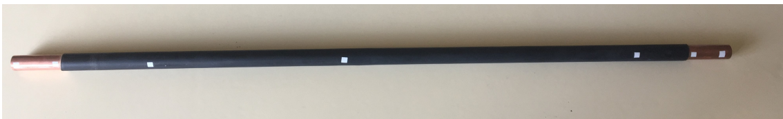
Figura 4.35: Tubo com manga termorretrátil HellermanTyton TAN32
