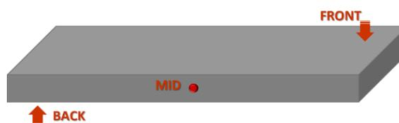
Figura 24 - Representação esquemática das amostras retiradas para avaliação de micro durezas ao longo da espessura do provete
