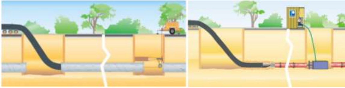
Figura 4 -Esquema ilustrativo do Entubamento simples ou SLIPLINING (fig. à esquerda), e do método PIPE BURSTING (fig. à direita)
