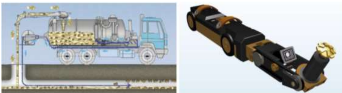
Figura 5 -Esquema ilustrativo da HYDRO JETTING (fig. à esquerda) e do Robot fresador (fig. à direita)
