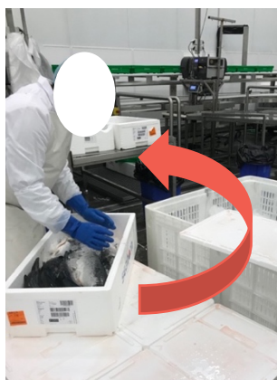
Figura 37. Atividade de abastecimento da linha. O operador retira o gelo da caixa para a tina de gelo e posteriormente coloca a caixa na bancada para pesagem.
