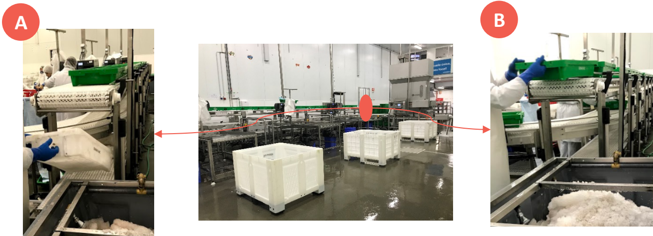
Figura 11. Abastecimento da linha com caixas higienizadas e recolha das caixas vazias. A) o operador retira as caixas vazias do nível inferior do tapete e B) abastece caixas higienizadas do CDP no nível superior do tapete.
