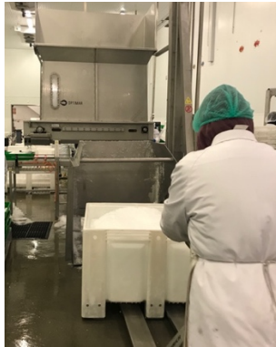
Figura 38. Atividade de abastecimento do dispensador de gelo.
