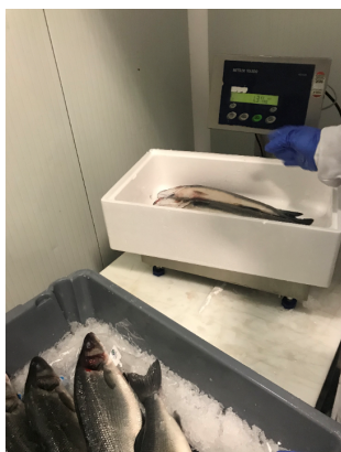
Figura 5. Amostragem de peso fixo. Nesta atividade, o operador pesa aleatoriamente 5 caixas de produto de um lote e averigua se a média do peso está de acordo com a informação do documento de receção do fornecedor.
