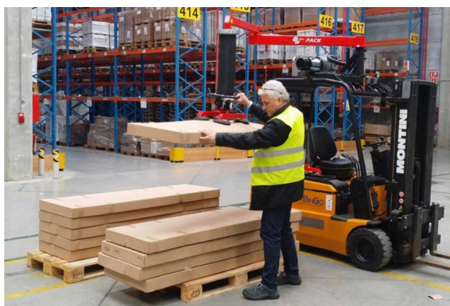
Figura 46. Processo de picking com recurso ao equipamento a vácuo (Retirado de: https://www.logismarket.pt/aog-smart-handling/solucoes-picking-cargas-leves-por-vacuio/4760712943 ).
