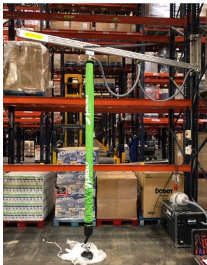
Figura 47. Equipamento de vácuo apoiado nas localizações de picking. Este equipamento será implementado nas futuras instalações do CDP (Fonte: Sonae MC, 2020).
