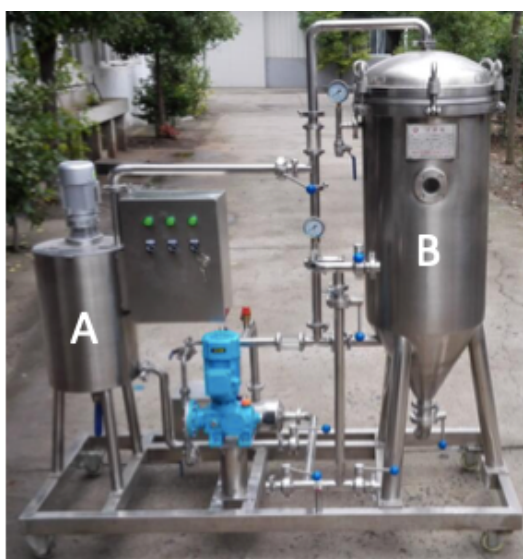
Figura 16 – Equipamento utilizado para a filtração por terras. (A) reservatório destinado à deposição das terras. (B) filtro de terras.
