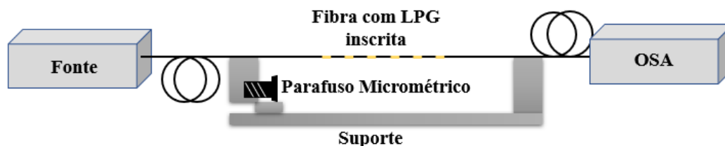
Figura 30 - Esquema da montagem experimental utilizada para a caracterização da sensibilidade das LPGs à deformação.
