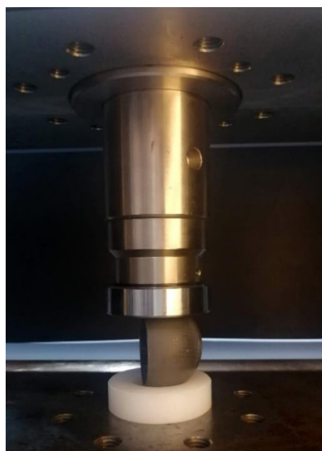
Figura 65 – Modelo CAD das estruturas desenvolvidas à esquerda. Fotografia da disposição das peças antes do ensaio mecânico de rutura da componente femoral sem suporte interno.
