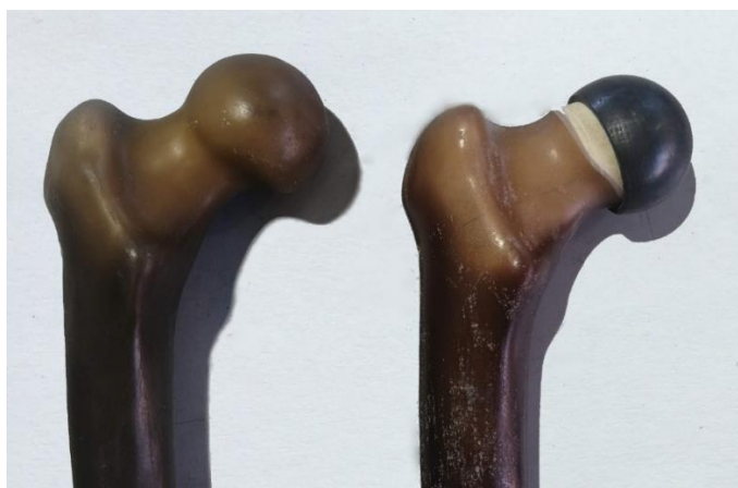
Figura 58 – Componente femoral fabricada implantada em osso sintético à esquerda e um modelo idêntico de osso sintético femoral intacto.
