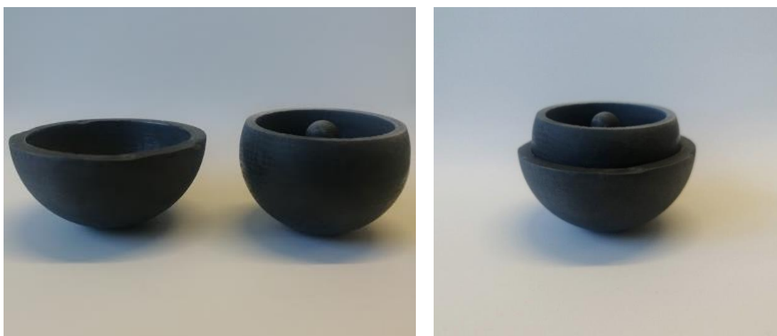
Figura 52 – Peças finais sinterizadas. Na fotografia à esquerda componente acetabular de diâmetro externo 59,3 mm (peça da esquerda) e componente femoral de diâmetro externo 49,7 mm (peça direita). Na fotografia da direita as mesmas componentes dispostas de maneira diferente.
