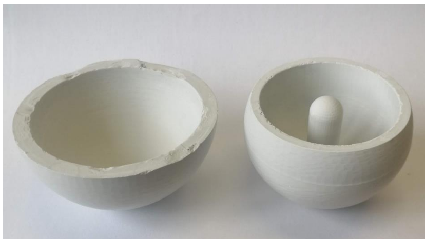
Figura 51 – Componente acetabular e componente femoral de Si_3N_4 em verde após maquinação. À esquerda componente acetabular de diâmetro externo 71,65 mm e à direita a componente femoral com 59 mm de diâmetro externo.
