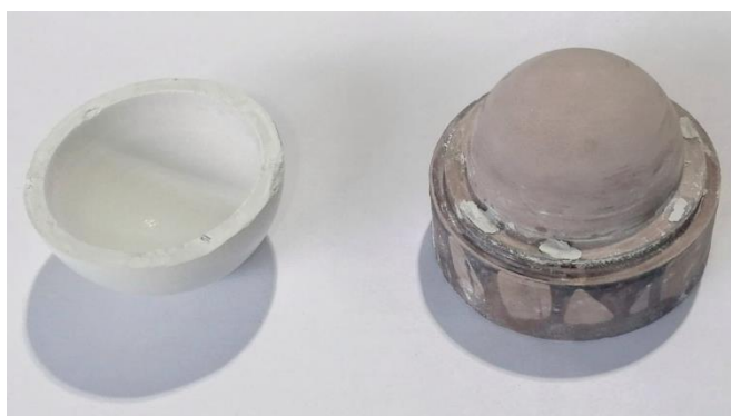
Figura 49 – Peça acetabular em verde após maquinação à esquerda e suporte auxiliar para peça acetabular à direita. Diâmetro externo da componente acetabular: 71,65 mm.
