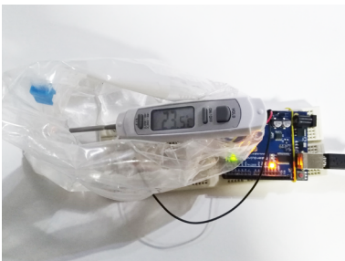
Figura 4.14 - Calibração do sensor de temperatura.
