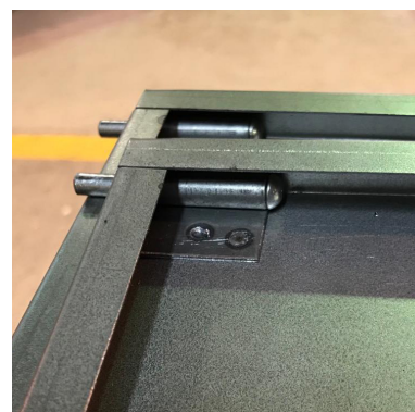
Figura 58 - Exemplo do sistema de perno soldado por pontos.
