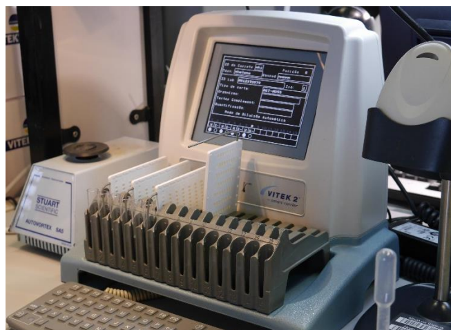
Figura 9: Identificação das cartas para TSA automatizado no equipamento VITEK® 2.
