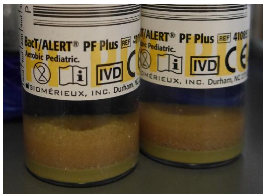
Figura 2: No fundo do frasco apresentam-se sensores de emulsão líquida que permitem a alteração de cor a detetar pelo equipamento.
