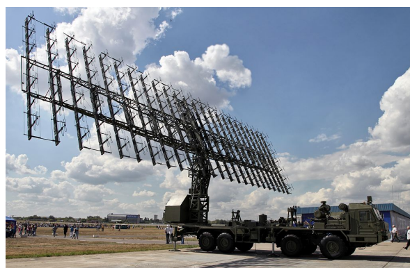
Figura 3.10: (Nebo-M), agregado de antenas construído pela Rússia [23]
