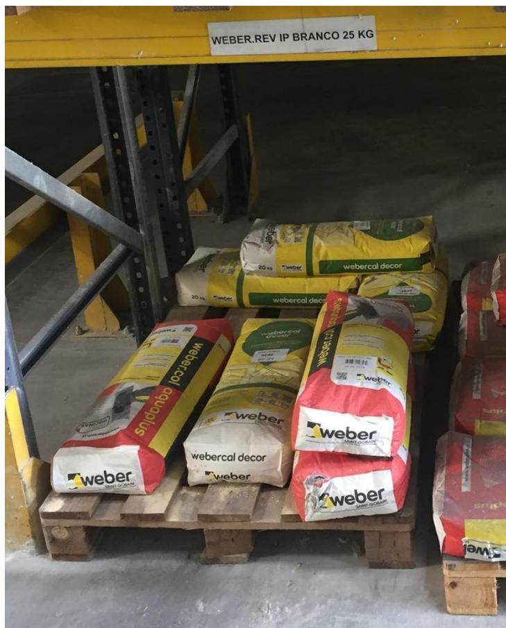
Figura 28: Produtos diferentes armazenados na mesma paleta e identificação errada do produto.
