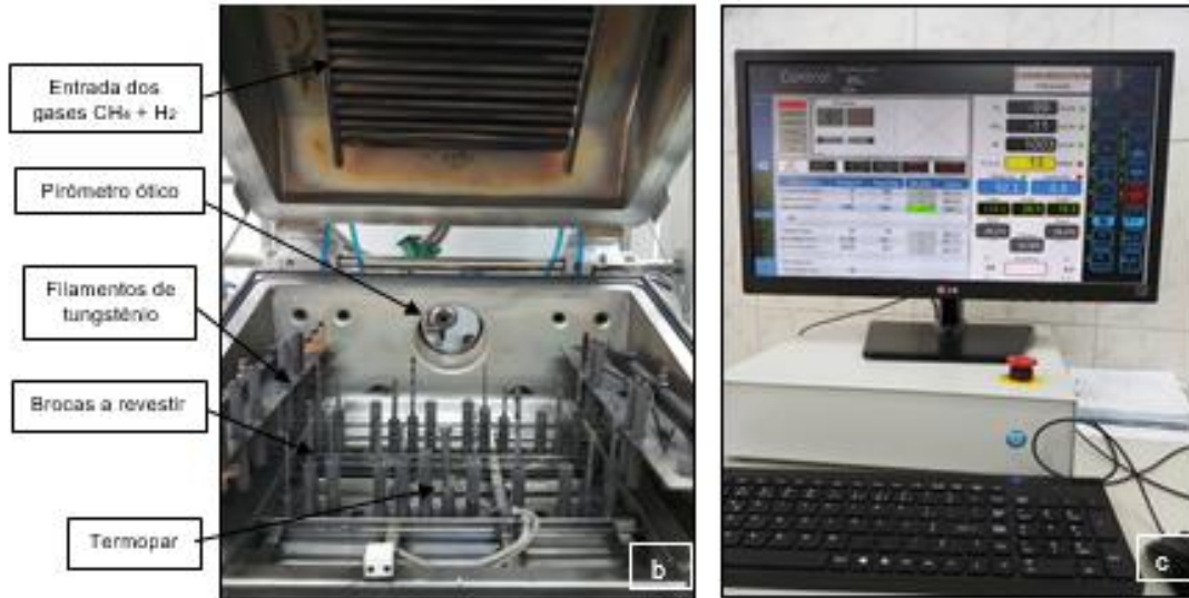
Figura 19: Reator HFCVD. b) Interior da câmara de reação, antes da deposição; c) Sistema de controlo/aquisição de dados.
