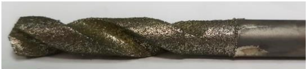
Figura 7: Fotografia de uma ferramenta convencional com revestimento eletrolítico, presente na Durit.
