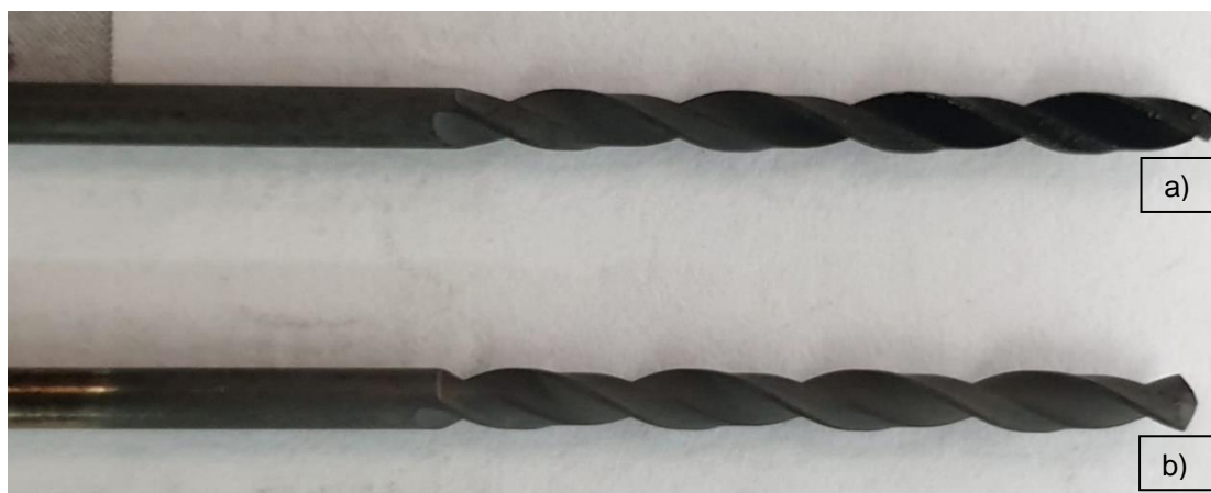
Figura 23: Aspeto das brocas após deposição de diamante CVD. a) revestimento com grafite; b) bom revestimento de diamante CVD.
