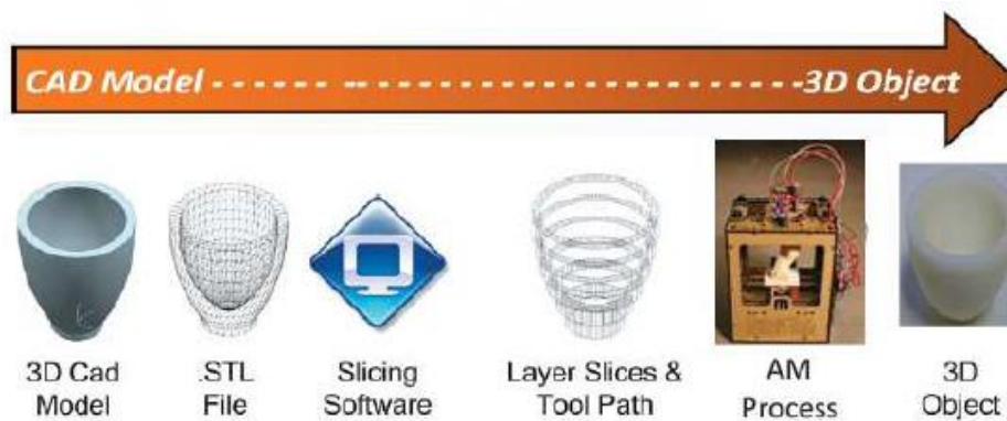
Figura 5. Etapas do Processo de AM [27].
