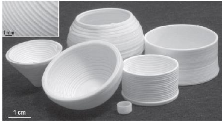
Figura 15. Material de laboratório em alumina, produzido por robocasting [41].
