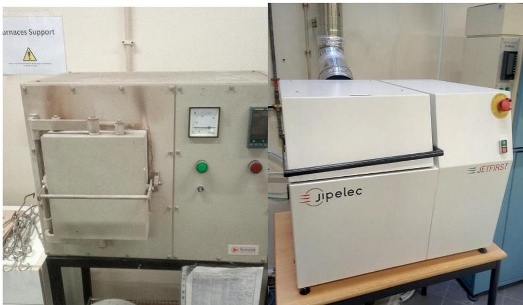
Figura 14- a) Forno utilizado no tratamento térmico convencional b) forno de RTA
