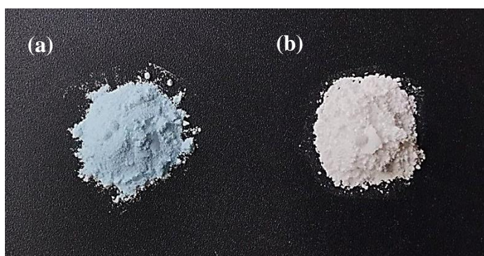
Figura 27 – Coloração dos pós de fosfatos de cálcio após calcinação a 1000 °C: (a) HA; (b) \beta -TCP.
