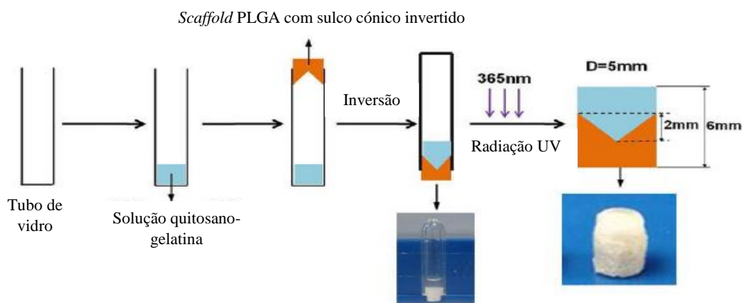
Figura 14 – Desenvolvimento de um scaffold através de um gradiente cónico. Adaptado de Han et al. 53
