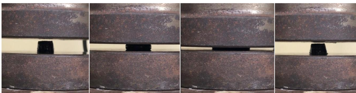
Figura 45 – Sequência de imagens do teste à compressão do hidrogel 5CH antes e após aplicação da força.
