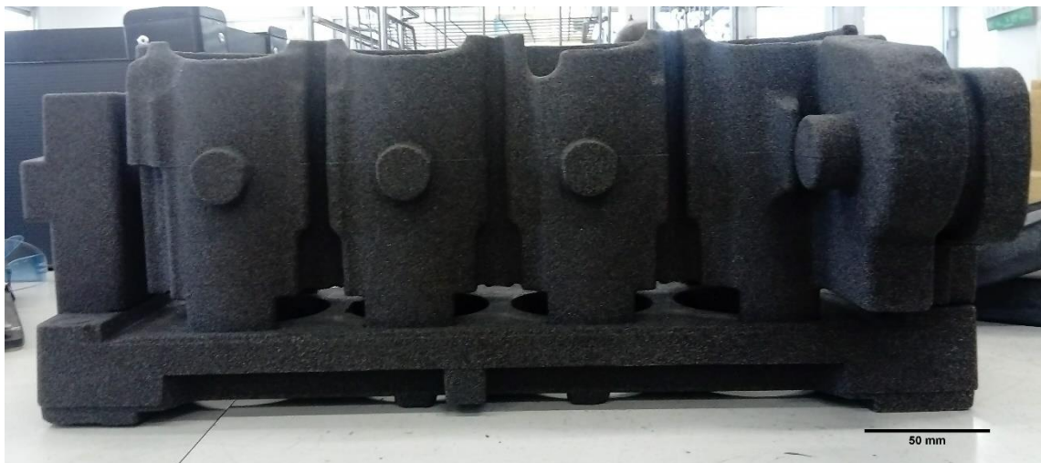
Figura 51 - Macho camisa/teto do bloco de motor 275 produzido com a nova formulação.
