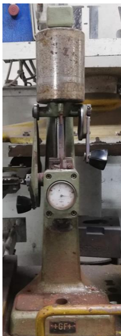
Figura 33 - Equipamento Georg Fischer PRA para compactar o provete para a permeabilidade.
