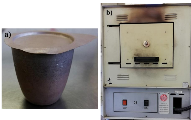
Figura 28 - a) Cadinho e tampa de platina e b) mufla OCRAS ZAMBELLI ZA .
