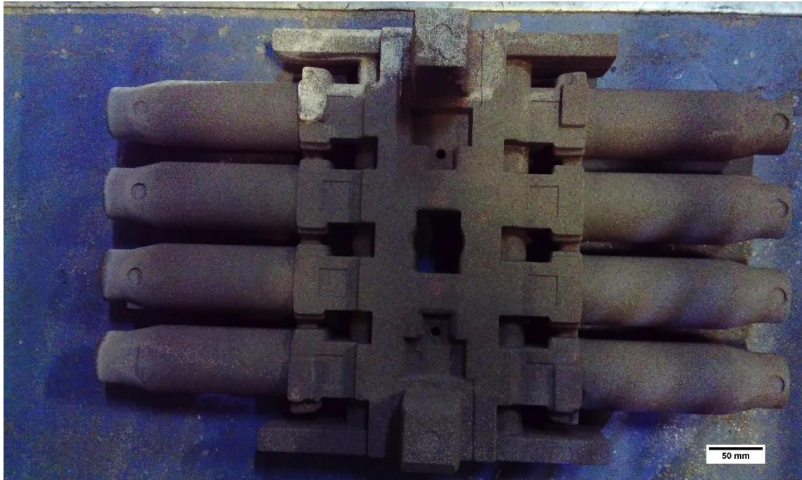
Figura 50 - Macho corpo/cilindro do bloco de motor 275 produzido com a nova formulação.
