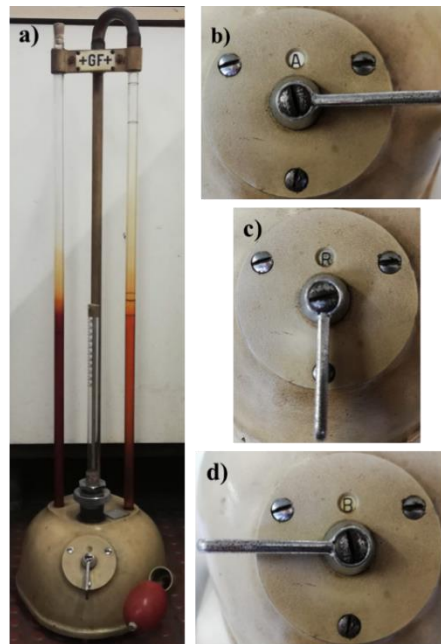
Figura 25 - a) Equipamento Georg Fischer POF usado na medição da superfície específica real; b) torneira na posição A; c) torneira na posição R e d) torneira na posição B.
