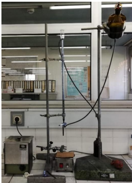
Figura 29 - Ultrassons LECO e conjunto de equipamentos Georg Fischer PMB usados na determinação da percentagem de argila ativa.
