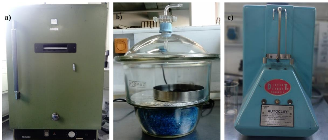
Figura 23 - Equipamentos utilizados para secar e lavar as areias: a) estufa PROLABO , b) excicador e c) Autoclave DIETERT DETROIT NO. 534-A .
