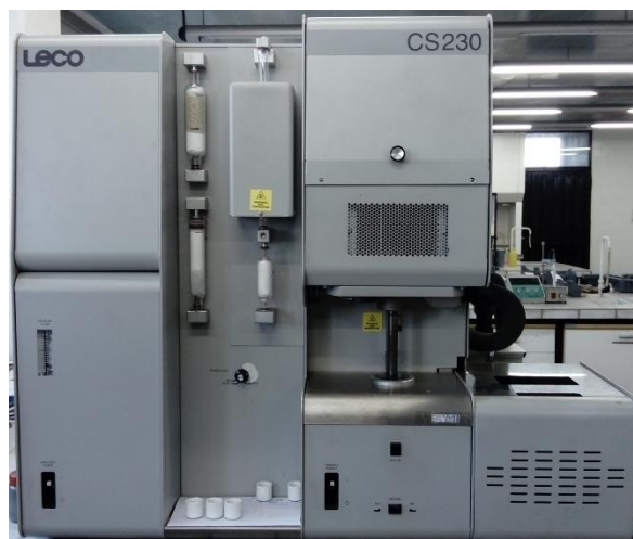
Figura 30 - Espectrômetro Leco CS230 utilizado na determinação da percentagem de carbono.
