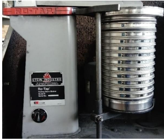
Figura 24 - Sistema TYLER Ro-Tap de agitação de peneiros e série de peneiros ASTM E 11 .
