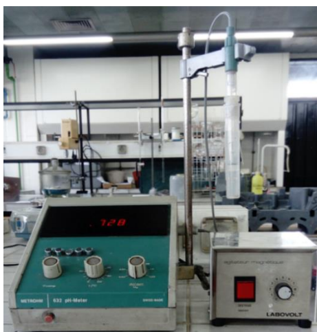
Figura 27 - Equipamento Brinkmann Metrohm 632 pH-Meter utilizado na medição do pH e agitador magnético LABOVOLT Secteur .
