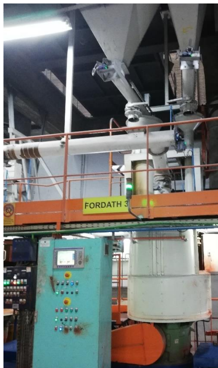
Figura 36 - Misturador FORDATH 3 , utilizado nos ensaios industriais.
