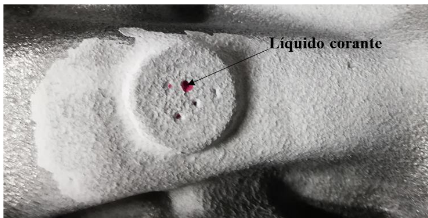
Figura 38 - Ensaio de líquido penetrante na zona do macho RO2.
