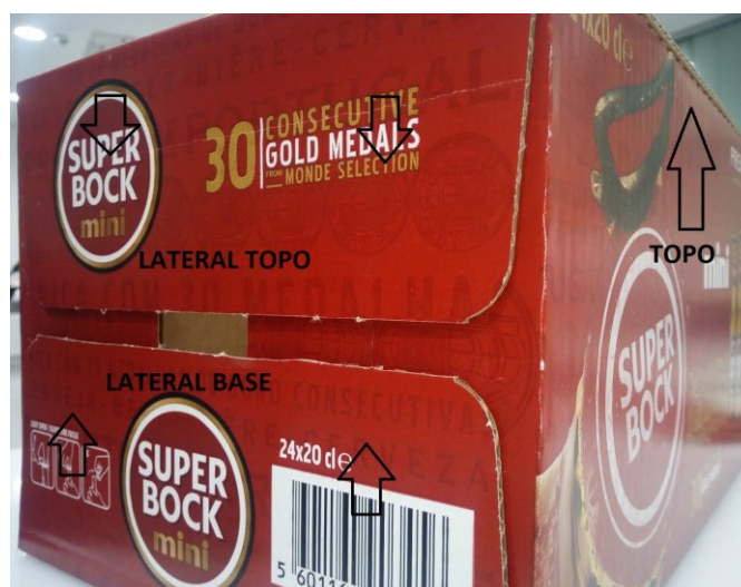
Figura 24. Exemplo de divisão de uma caixa 24x20 cl para ensaios de força de abertura.
