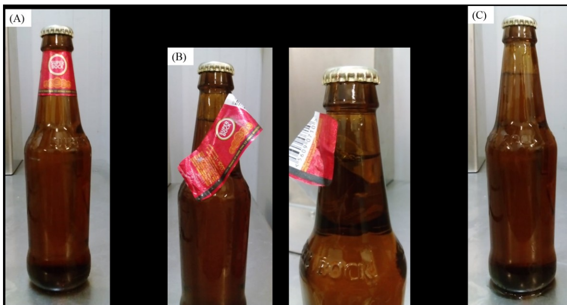
Figura 28. (A) Garrafa TR após 5 minutos em água gelada. (B) Garrafa TR após 20 minutos em água gelada. (C) Garrafa TR após 30 minutos em água gelada.
