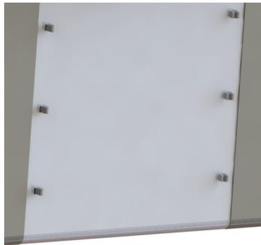
Figura C.1: Pormenor dos *Snap-Fits* para Encaixe ao Suporte
