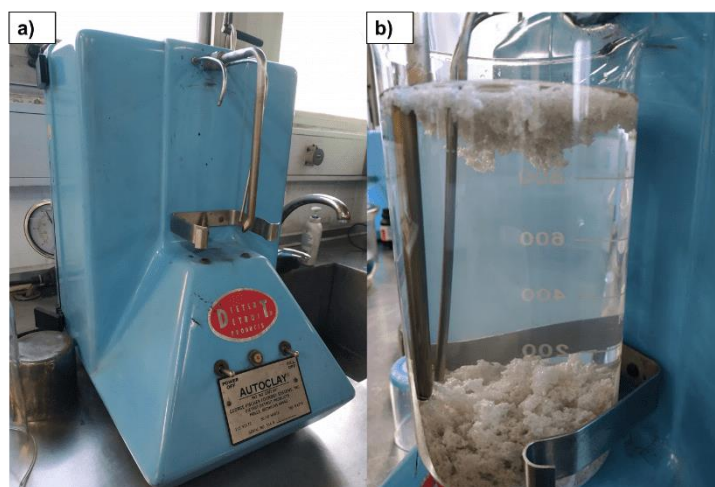
Figura 16 - Aparelho de lavagem automática "Autoclay DIETERT DITROIT NO. 534-A" (a) e tentativa de determinação de finos (b).
