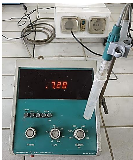
Figura 21 - Aparelho Metrohm 632 pH-meter para a medição de pH.
