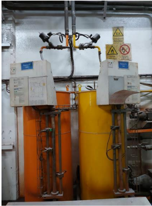
Figura 5 - Resinas da secção da macharia: Isocure 340 (laranja) e Isocure 640 (amarelo).
