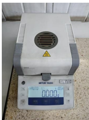
Figura 19 - Aparelho para medição do teor em humidade “Mettler HE53”.
