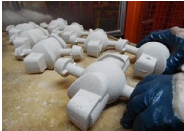
Figura 9 - Exemplo de machos produzidos pela Funfrap – Fundição Portuguesa, S.A. [2].
