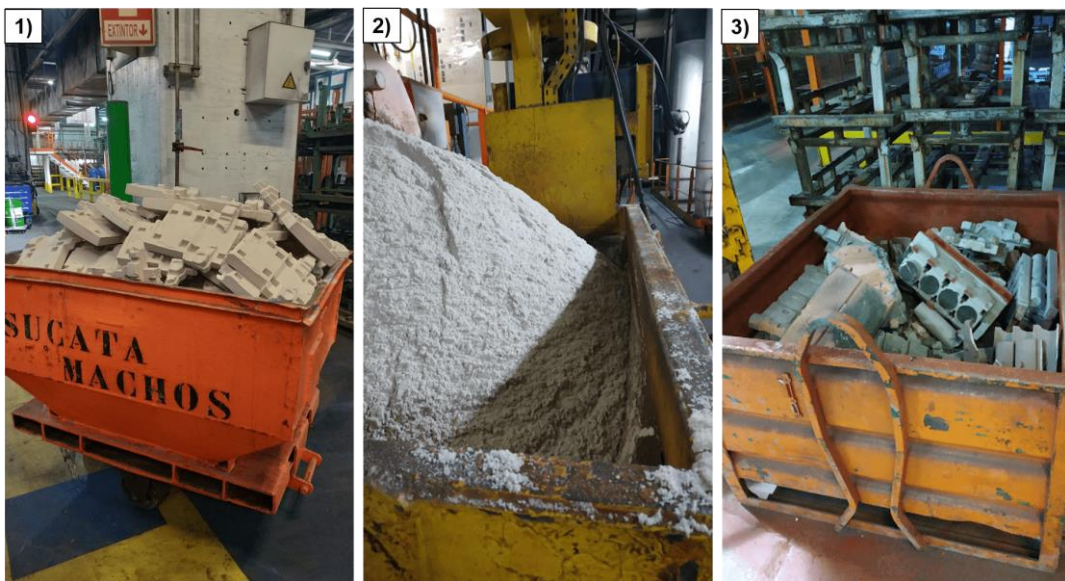
Figura 29 - Sucata de macharia: machos sem tinta (1), cargas descartadas (2) e machos com tinta (3).
