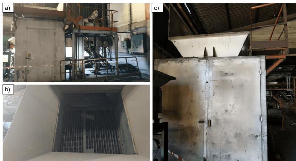
Figura 28 - Partidor de machos “Klein” (a) e (c) e grelha de destorroamento (b).
